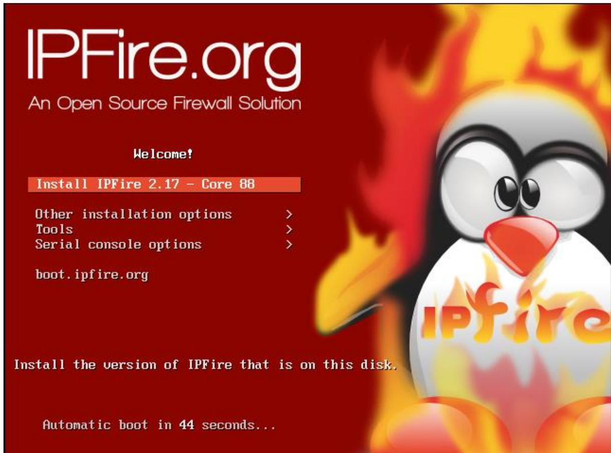
Par défaut, la ligne d'installation est sélectionnée. C'est ce que l'on souhaite, donc on appuie sur la touche "Entrée".
